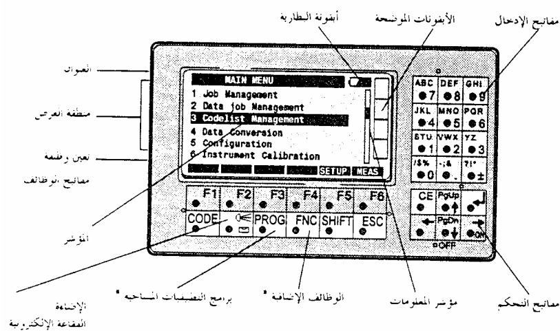
شكل رقم (٧) يوضح الشاشة ولوحة المفاتيح لجهاز المحطة الشاملة Leica TPS 1100
